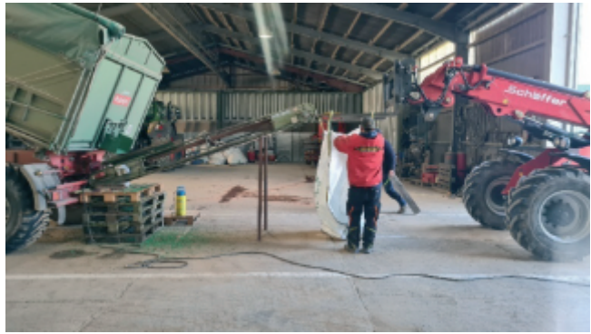
Abbildung 3: Seit diesem Jahr wird das Saatgut auf dem Förderband geimpft und anschließend in Big Bags gefüllt. Unser Standardprodukt ist Rizoliq Top S. Foto: Josefine Reichmuth
