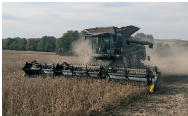
Abbildung 4: Mit einem Flexschneidwerk, kann der Drusch sehr tief erfolgen. Foto: Tommy Herzog
